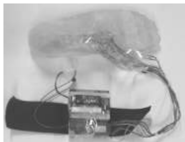
Figura 1: Foto do protótipo de captura dos dados utilizados na identificação do modelo. Na imagem são mostrados os sensores FlexiForce® conectados a uma placa de aquisição com um buffer e um estágio de ganho conectado ao microcontrolador Msp430f2274 (rf2500).
