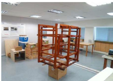
Figura 1: bobina triaxial de Helmholtz a ser mensurada mecanicamente.
